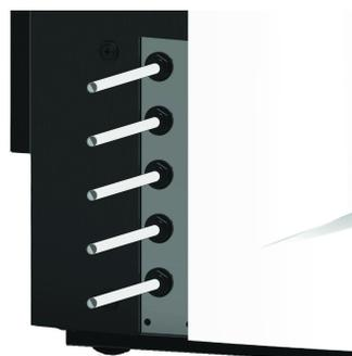
5) Anschluss 6 ist die manuelle Tankentleerung, lassen Sie den Stopfen eingesteckt.
